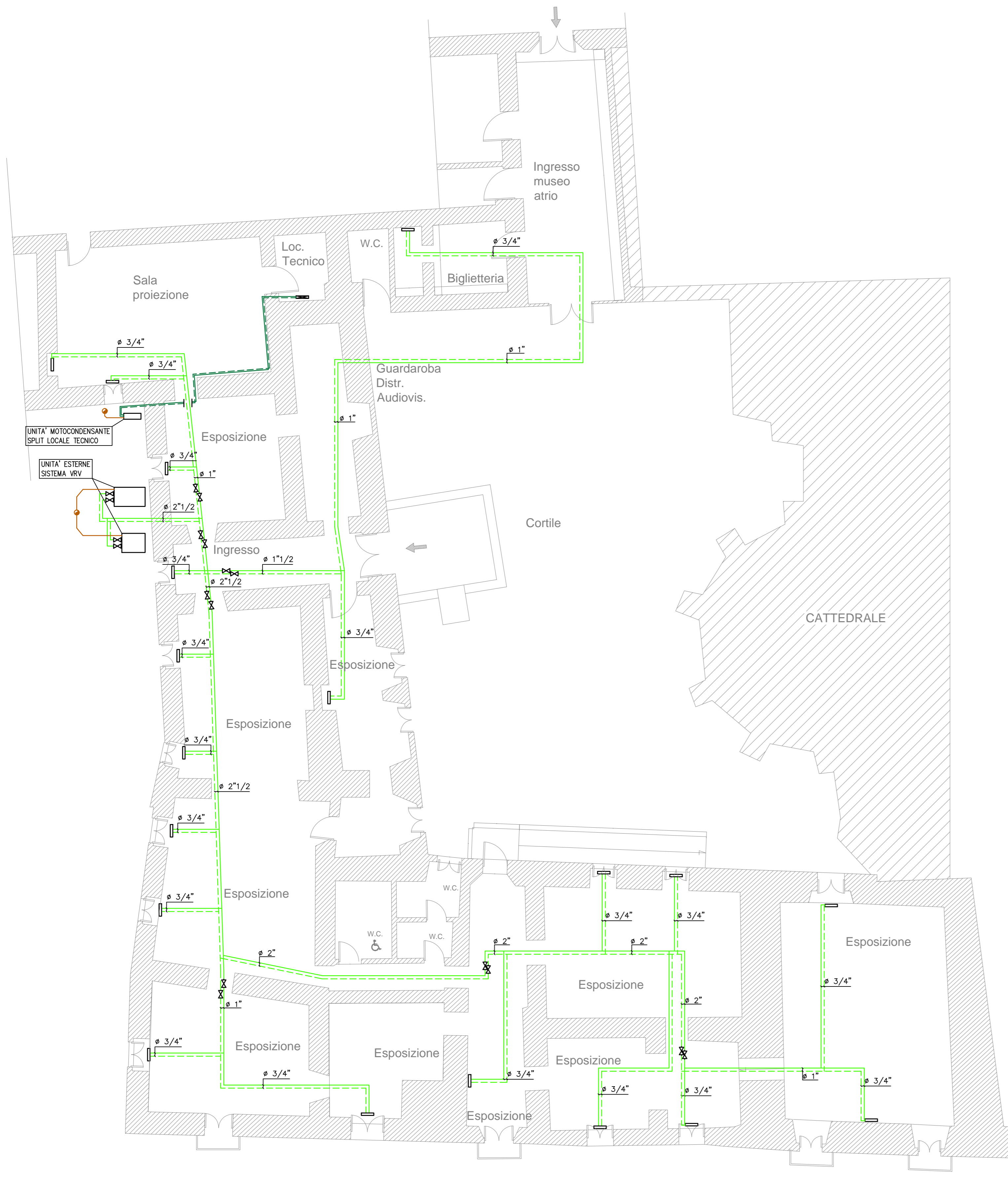
IMPIANTO IDIRCO - SANITARIO Scala 1:100
